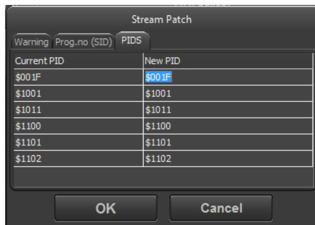
*Illustration 15: Patching of PID und SID-allocation*
