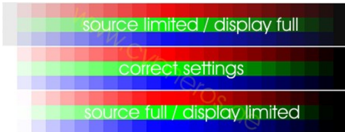
Illustration 1: Effet d'un mauvais réglage “video_full_range_flag”
